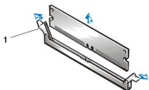
Figura 3. Desmontaje de un módulo RIMM
